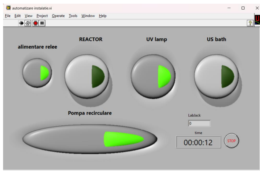
Figura 20 – Interfața de comandă a automatizării REM
